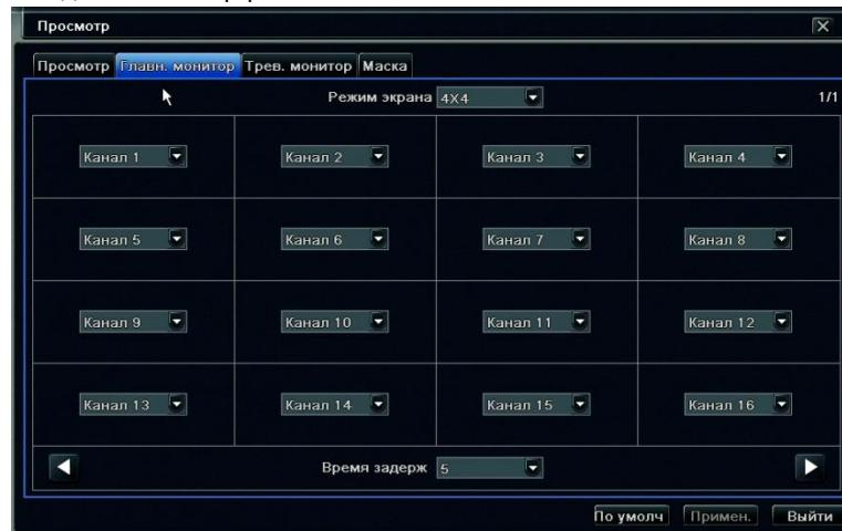
Рис. 4.9. Настройка главного монитора.
