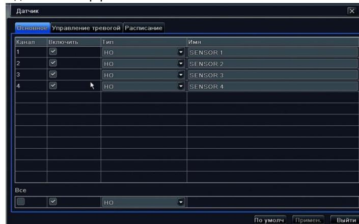
Рис. 4.20. Настройка основных параметров тревожных входов.
